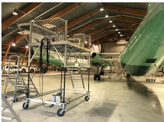
Arbeidsplattform med elektrisk hev og senk, strømuttak og nedfellbart arbeidsbord
