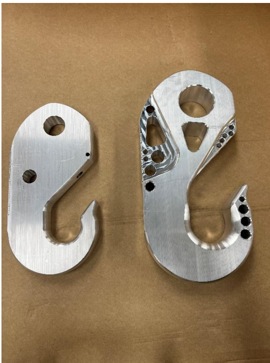
Standard 32mm tykk krok med WLL 7,5T pr. krok Spesial 50mm tykk krok med WLL 15T pr. krok
