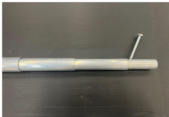
Stoppehjelpen til å stå på bakken og hekte av/på stropper på båt på lastebil Sammenslått 1,7m utslått 4,1m (teleskopisk) Vekt 1,5kg.
