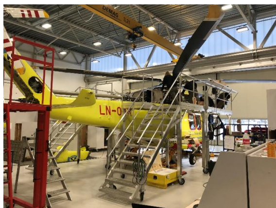
To sidig arbeidsplattform med hev og senk + service funksjoner som lys, strøm og trykkluft
