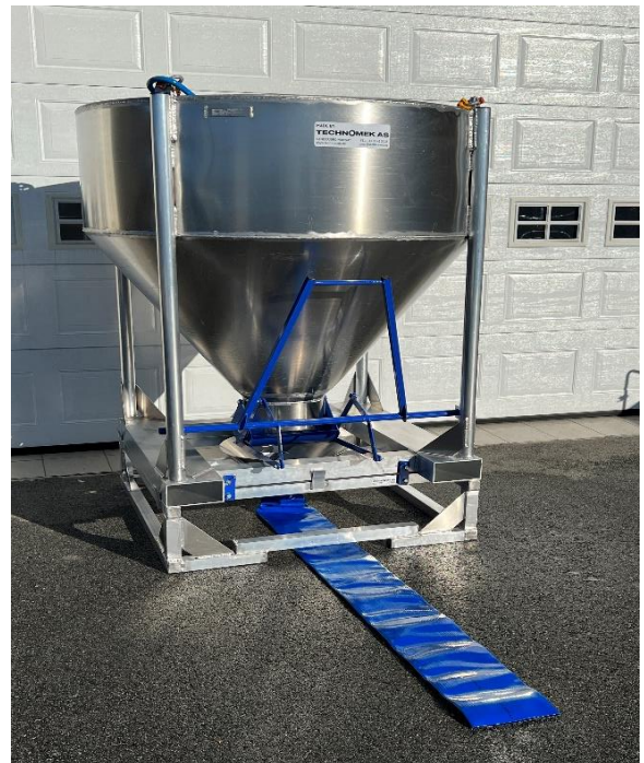
1000 liters tobb med løs bunnramme for trakt samt gaffelfester for truck og traktor
