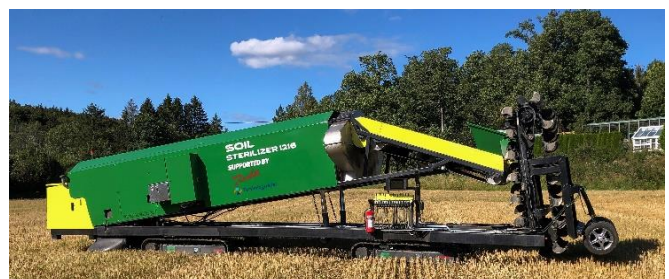
Eksempel på egenutviklet og bygget maskin. Maskinen er en jord desinfiserings maskin på 12 tonn med lengde 12,5 meter
