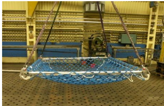
7 tonns åk med nett for løfting av isolasjon
