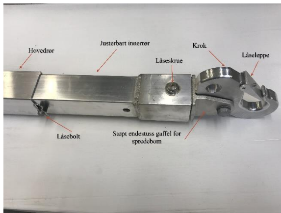
Spredébom med firkant 100x4 og 104x6mm rør
